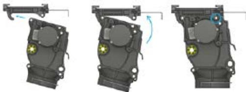
Une simple manipulation permet d'accoupler le doseur.
