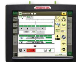
Un terminal permet de gérer la coupe de rang et la modulation de dose de vos **MicroSmart** et ce via un GPS. Jusqu'à 7% d'économie.
