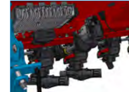
Fertiliseur FertiSmart Avec entraînement ISM (Integrated Smart Motors) Un moteur pour plusieurs doseurs
