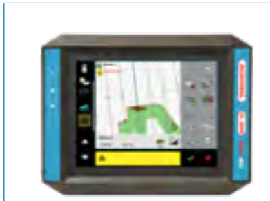
Terminal Isobus Monosem Touch Mini Avec faisceau tracteur
