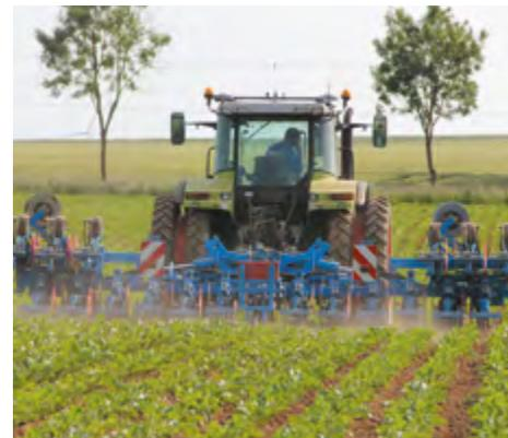
Partiellement repliée, la bineuse Grande Largeur peut également biner 8 rangs ou 12 rangs «maïs». Cela permet d'utiliser une même bineuse sur des parcelles semées avec des semoirs de différentes largeurs !
