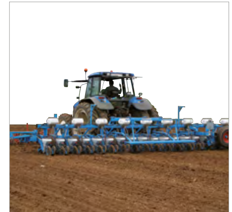
Semoir MECA V4 rigide triple-barre 18 rangs avec Microsem et chariot de transport
