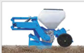
En «Jauge arrière», le contrôle de la profondeur est assuré par le bloc tasseur arrière.
