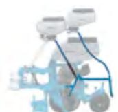
Notre microgranulateur dispose de deux descentes en fonction du produit à distribuer. Une voie dans la ligne de semis et une voie à l'avant ou à l'arrière des roues tasseuses.
