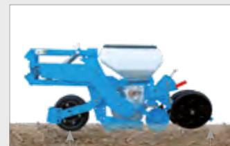
En «Balancier», le contrôle de la profondeur est assuré par la roue avant et le bloc tasseur arrière. Un ressort de réglage permet la répartition de charge avant/arrière jusqu'à un contrôle de profondeur «Jauge avant».
