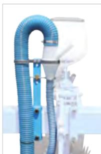
Des cyclones montés en face chaque élément permettent la chute de l'engrais par gravité limitant ainsi la formation de poussières engendrée par l'air pulsé.
