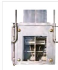
La distribution 100 % inox du fertiliseur avant dispose de deux trappes de fermeture et se démonte rapidement.
