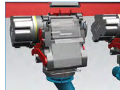
Fertiliseur FertiSmart Avec entraînement MSM (Monosem Smart Motors) Un moteur par doseur
