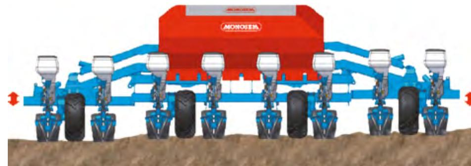
Les châssis repliables Double-barre et TFC flottant disposent d'extrémités indépendantes avec blocs roues. Cette caractéristique permet un parfait suivi du terrain.
