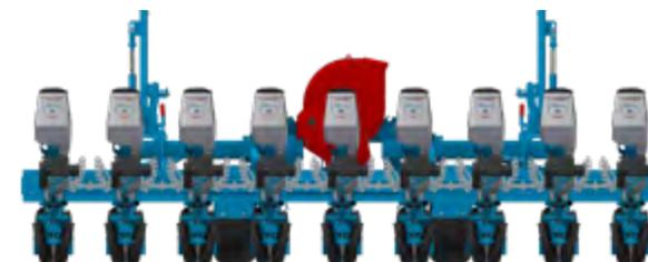
Exemple de configuration : 9 rangs à 50 cm
