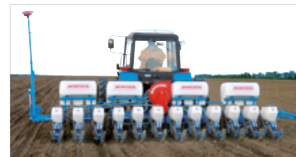
Semoir NC Technic Betterave 12 rangs rigide Monobarre (45cm) - Fertiliseur 4x175L. à socs
