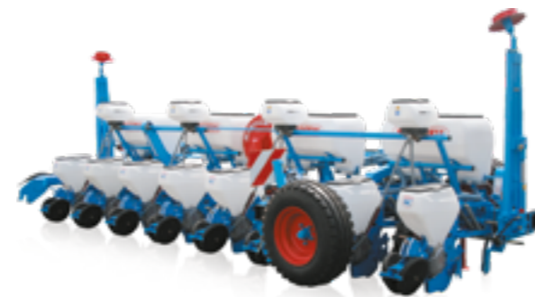
Semoir NC Technic Maïs 8 rangs rigide (70cm) - Fertiliseur 4x175L. à socs
