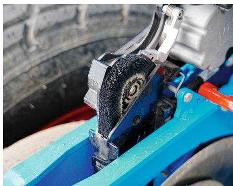
La courroie à brosse accompagne ensuite la graine dans le sillon avec une régularité constante et sans rebond.
