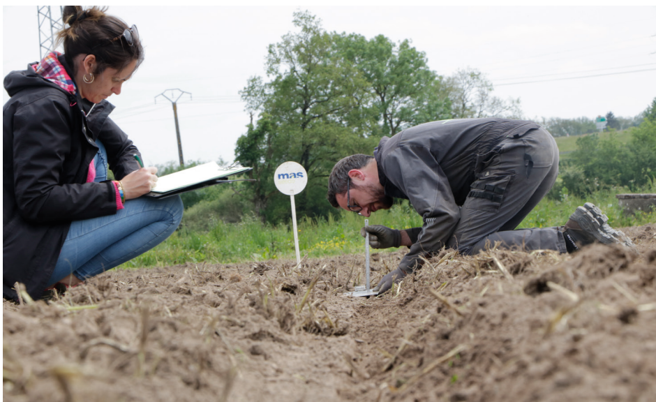
Le sillon de contrôle, situé en dehors des passages de roues du tracteur, est rouvert sur 13,3 m afin de réaliser les mesures.
